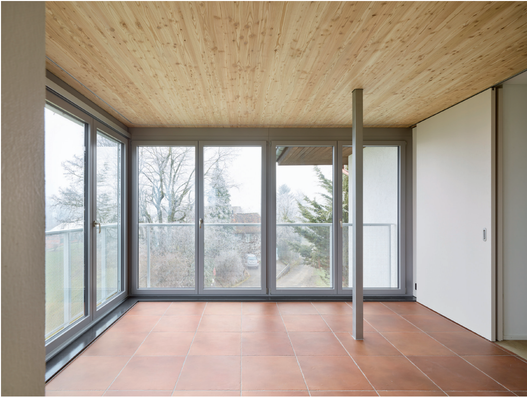
Das «Jahreszeitenzimmer» – sowohl Innen- als auch Aussenraum. Die Fassade wird mit der Wandverkleidung, die Dachuntersicht über die Holzdecke in den Raum geführt
